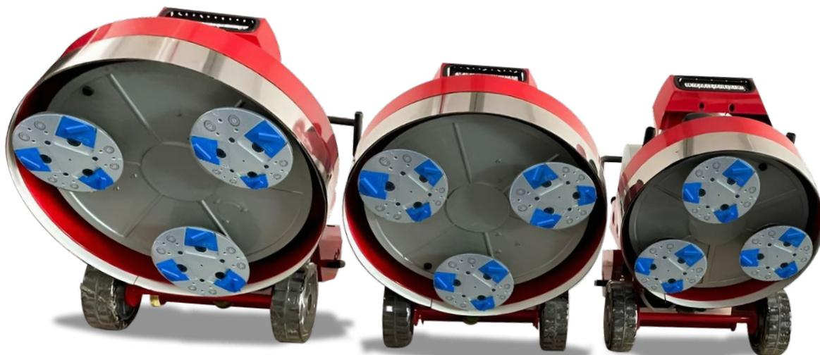
Для таких машин используется алмазный инструмент под названием ПАД. Пады могут отличаться по форме в зависимости от производителя. Мы всегда имеем на складах два самых популярных типа:
