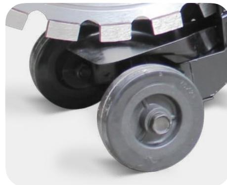
Кольцевой диск режет на глубину до 290 мм, что соответствует обычному алмазному диску диаметром 600 мм
