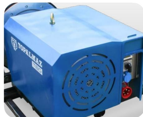
Модель WS 37 оснащена мощным двигателем 37 кВт. Скорость каната в 2 раза быстрее, чем у базовых моделей и можно использовать канат длиной до 100 метров. Скорость каната можно настроить под вид материала.
