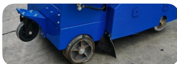
Гидропривод сам передвигает резчик с той скоростью, которую установит оператор
